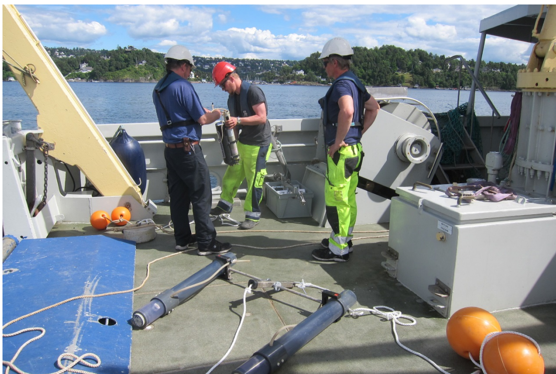
Figur 1 Bilde tatt under utplassering av sedimentfeller den 21. juni 2016. Rigg til sedimentfeller klargjøres med blåser, moring og akustisk transponder. Foto: NGI
