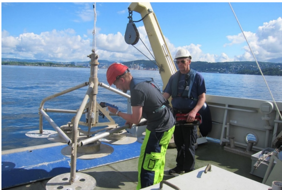
Figur 6 Bilde tatt under utsetting av tripod med 3 diffusjonskamre den 21. juni 2016. Foto: NGI
