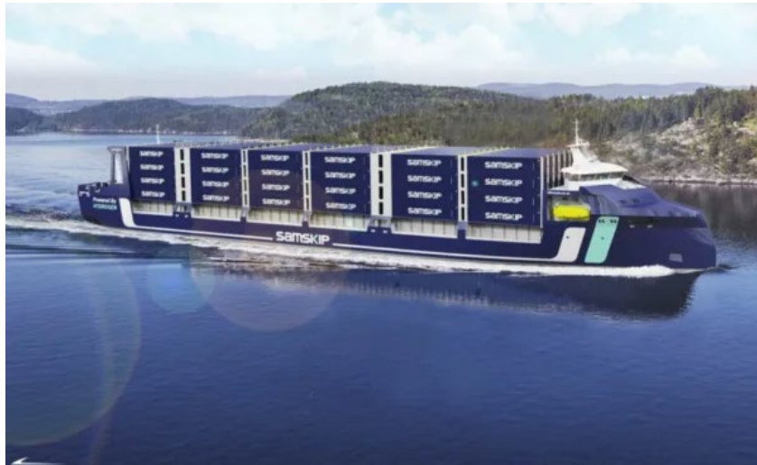
Samskip's SeaShuttle. Flytende hydrogen lagres i tanker akter på dekk. Illustrasjon: Samskip
