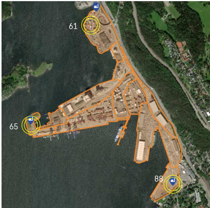
Figur 46 Angir sikkerhetsavstander etter forslag i DSB temaveiledning. Indre og midtre sone er angitt med sirkler med radius hhv 63m og 85m.
