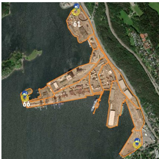
Figur 72: Sikkerhetsavstander for produksjon og lagring av komprimert hydrogen hhv. område 61, 66 og 88 med utgangspunkt i DSBs veileder på høring her fremvist med halvert sikkerhetsradius ift. veilederen til DSB.
