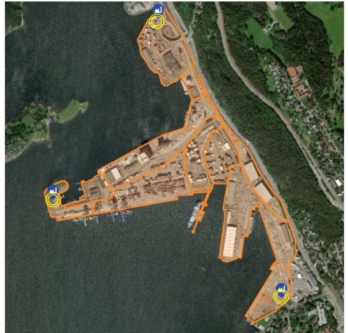
Figur 47 Angir sikkerhetsavstander med halvert radius i forhold til forslag i DSB temaveiledning. Indre og midtre sone er angitt med sirkler med radius hhv 31m og 43m.
