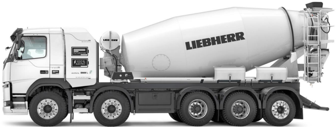
Figur 28: 5-akslet helelektrisk betongbil fra Liebherr. (Kilde: Electrive.com)
