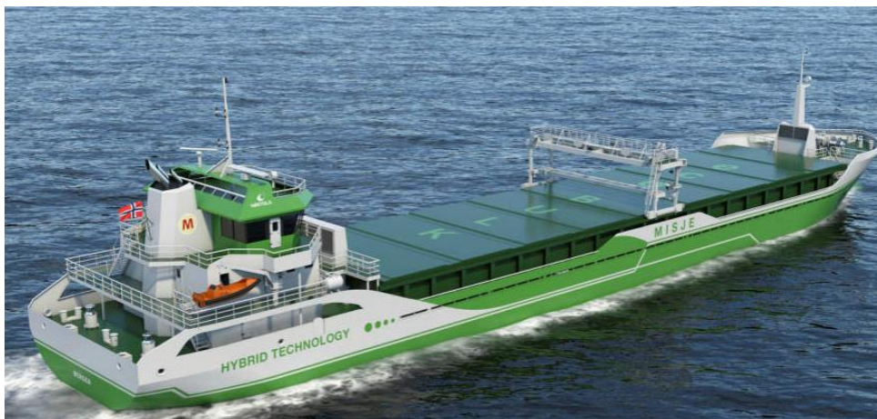
Figur 20 Misjerederi: Hybridskip med landstrømtilkobling med muligheter for å lade batteri og seile utslippsfritt inn- og ut til havner. (Kilde: TU)
