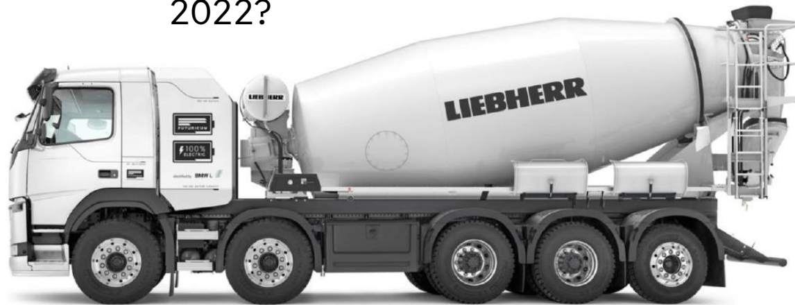
Figur 28: 5-akslet helelektrisk betongbil fra Liebherr. (Kilde: Electrive.com)
