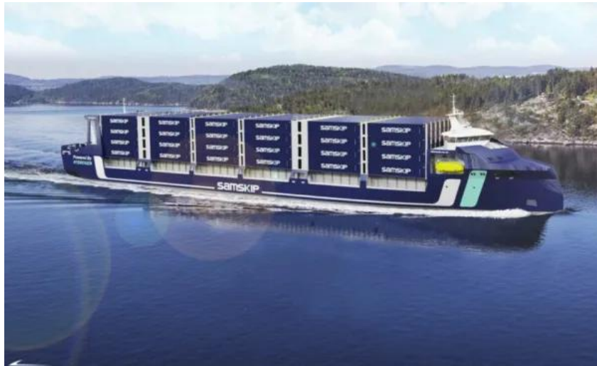
Samskip's SeaShuttle. Flytende hydrogen lagres i tanker akter på dekk, foto: Samskip
