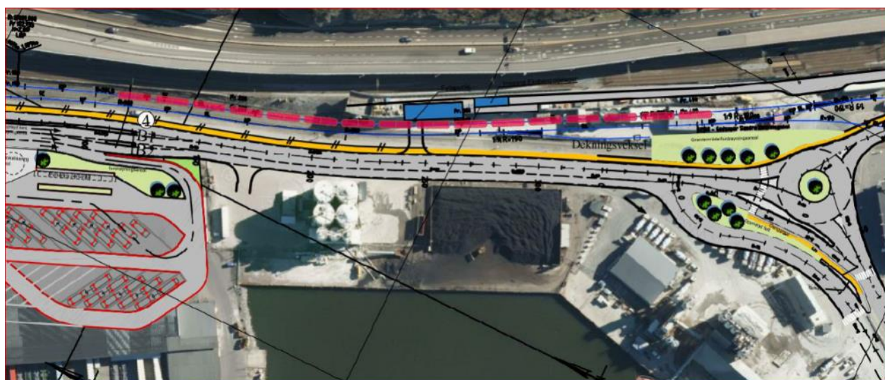
Figur 8 Ny plassering av fyllestasjon for flydrivstofftoget. Fyllestasjon i blått, tog som tankes vist i rødt. (6)
