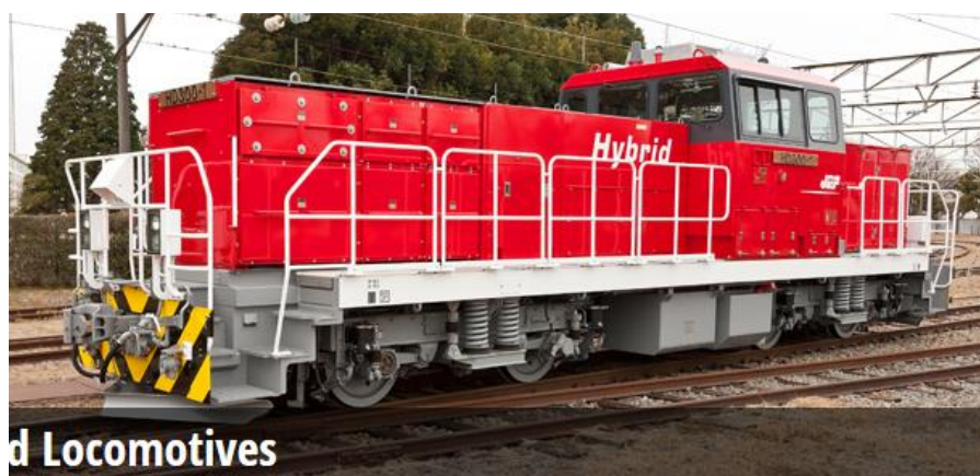
Bilde 6 - Elektrisk skiftelok med batteripakke
